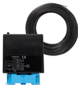
Индукционна намотка Детектор на индукционна верига с нормално отворен контакт и превключващ контакт, с регулиране между импулсен и продължителен контакт, разпознаване на посоката, 50 m кабел за индукционна верига
